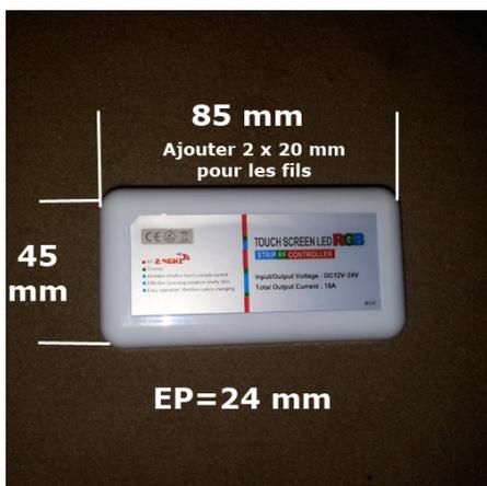
Ce contrôleur permet de gérer 12 mètres de ruban à leds en 60 leds/m (sections de 5 mètres max pour éviter les pertes d'intensité lumineuses après les 5 premiers mètres) ou 24 mètres de rubans en 30 leds/m.
