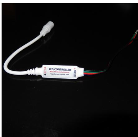
Chaque contrôleur utilise une fréquence propre. Vous pourrez ainsi utiliser 2 ou plusieurs contrôleurs RGB à proximité, sans qu'il y ait un conflit entre les 2 appareils. 1 télécommande = 1 contrôleur.
